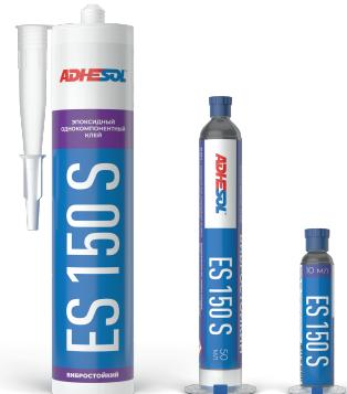
**ADHESOL ES 150 S** – однокомпонентный эпоксидный клей, отверждаемый нагревом. Формирует соединение, стойкое к вибрации и ударным нагрузкам, подходит для фиксации материалов с разным тепловым расширением. При отверждении состав не растекается, склеивает детали с зазором до 5 мм. Не является диэлектриком.
